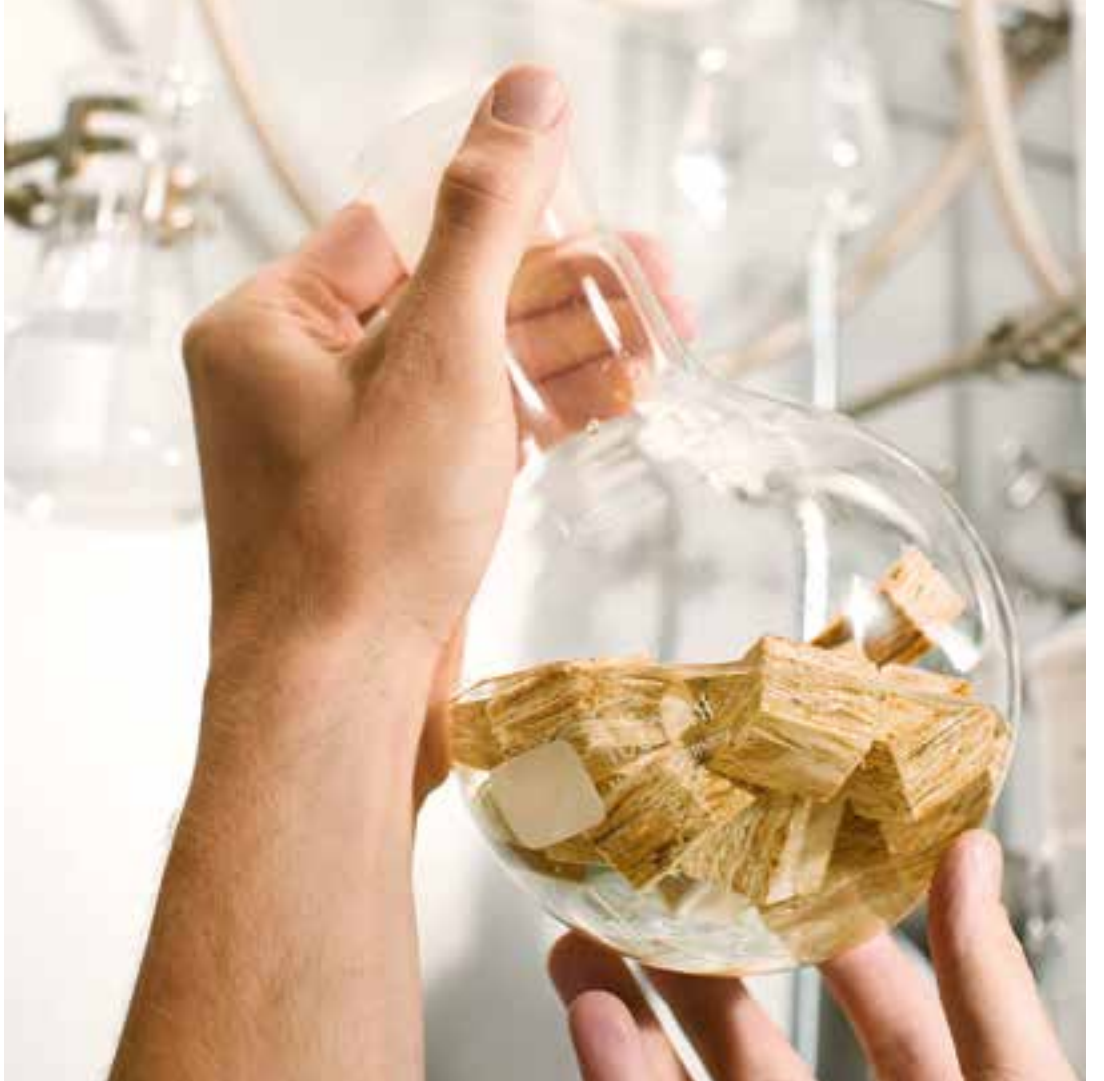
Laboratuvarda ahşap: Perforator toluol ile yapılan ekstraksiyonla ve arkasından ahşap ham madde plakaların formaldehit içeriklerinin fotometrik olarak belirleyebilmek için kullanılan bir test aparatıdır.
